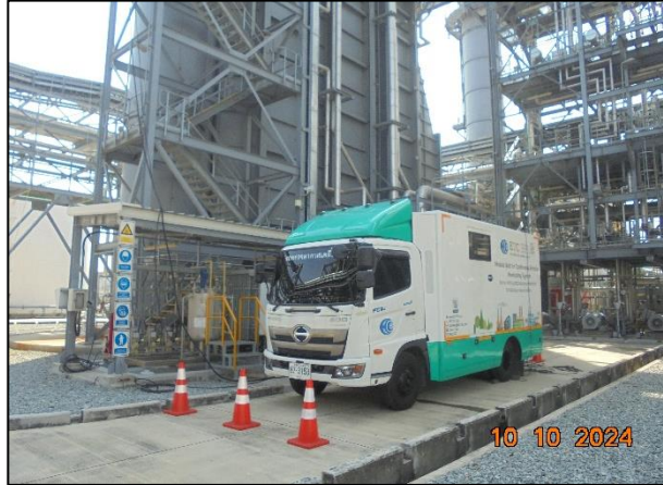
ภาพที่ 3 แสดงการตรวจวัดเพื่อทดสอบความแม่นยำสัมพัทธ์ ระบบ CEMS สำหรับตรวจวัดก๊าซ ของบริเวณ ปล่องหน่วยผลิตไอน้ำ HRSG# 32
