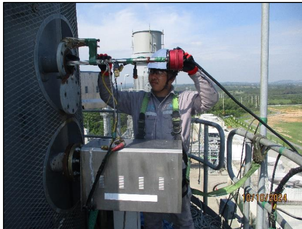
ภาพที่ 4 แสดงการตรวจวัด RM Method ของบริเวณ ปล่องหน่วยผลิตไอน้ำ HRSG# 32
