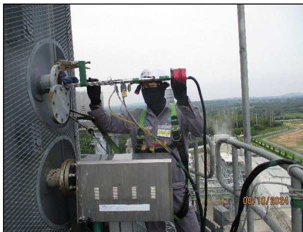
ภาพที่ 2 แสดงการตรวจวัด RM Method ของบริเวณ ปล่องหน่วยผลิตไอน้ำ HRSG# 31
