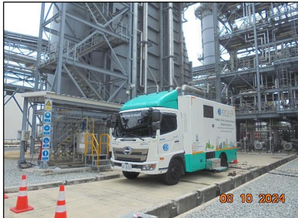
ภาพที่ 1 แสดงการตรวจวัดเพื่อทดสอบความแม่นยำสัมพัทธ์ ระบบ CEMS สำหรับตรวจวัดก๊าซ ของบริเวณ ปล่องหน่วยผลิตไอน้ำ HRSG# 31
